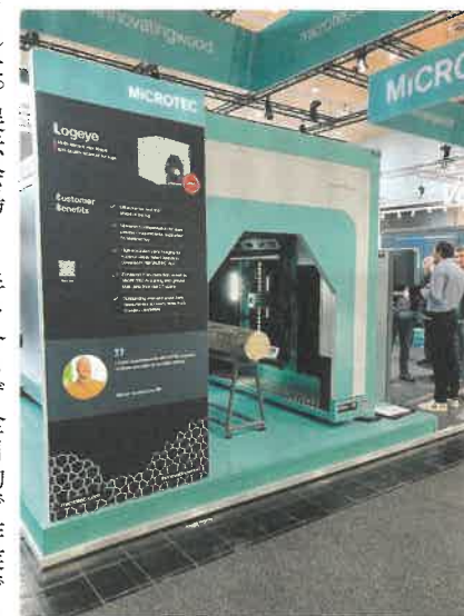
マイクロテック社のウッドスキャナカメラ・レーザー・X線で欠点を自動判別
